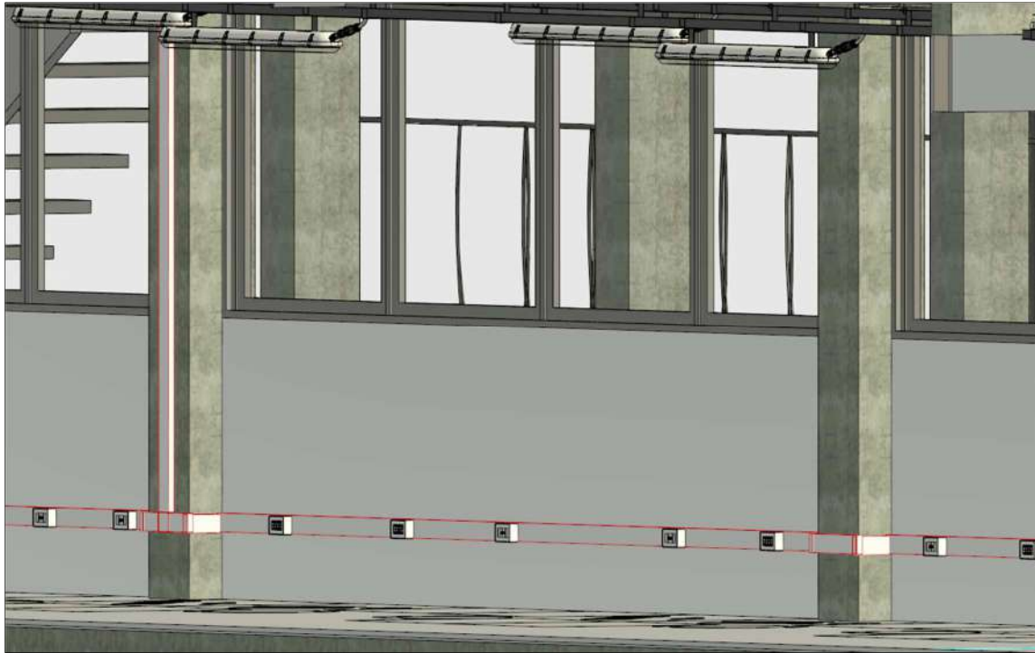
Figura 6 – Canaleta de alumínio para as tomadas da área administrativa.
