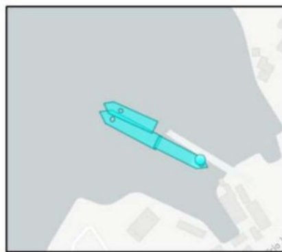
Figura 18. Alvos AIS com erros de rumo e posição
