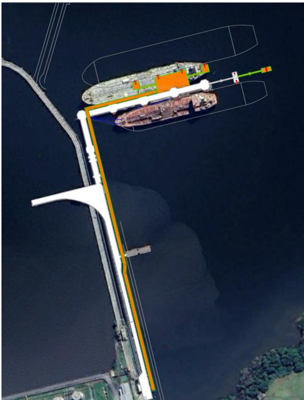
Figura 2 - Píer Público de Graneis Líquidos (Ponte de acesso, Píer Secundário e Berços), estruturas existentes na cor branca, e estruturas a serem executadas nesta obra em laranja.
