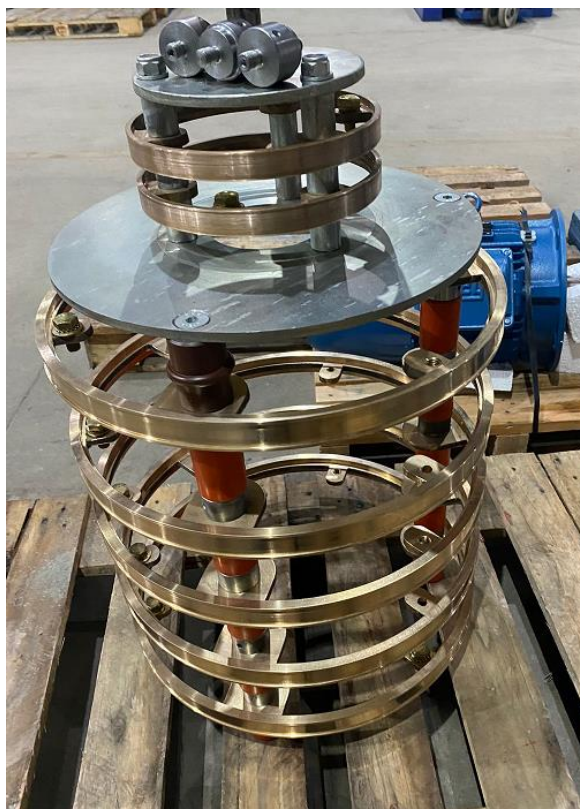
Figura 1 - Conjunto de anéis coletores atuais retrabalhados após incidente. Foi alterada a quantidade de anéis de 6 para 5 de forma paliativa.
