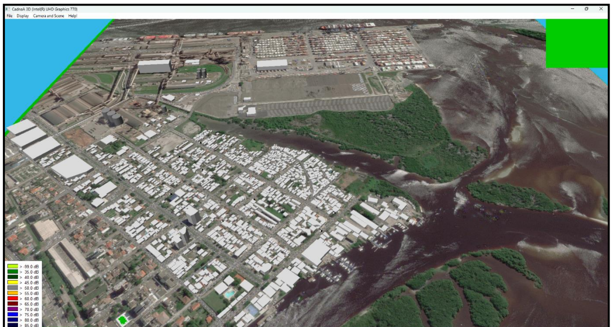
Figura 30 – Exemplo em 3D de parametrização de modelo para mapeamento acústico estratégico do bairro Costeira, vizinho da área do porto organizado de Paranaguá.
