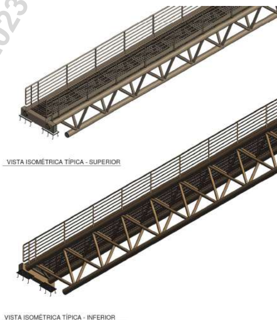
Figura 4: Vista 3D das passarela metálicas
