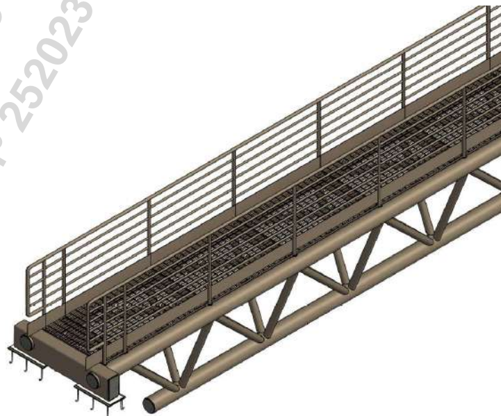
Figura 5: Vista 3D – Passarelas metálicas de acesso
