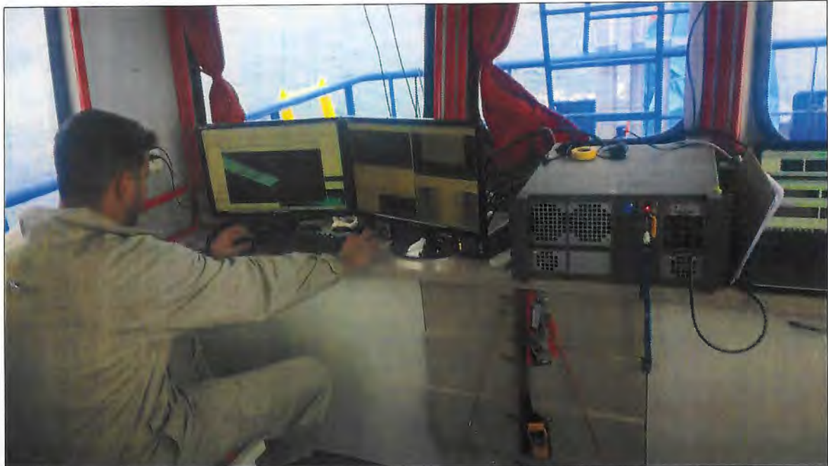
Figura 6. Bancada do sistema de aquisição de sonografia de varredura lateral (SSS), instalada na embarcação "Sangue Bom".
