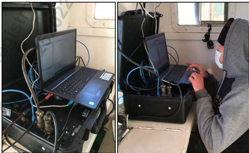
Figura 9. Ecobatímetro ODOM ECHOTRAC CVM em operação na campanha de batimetria, operando na frequência 200 kHz.
