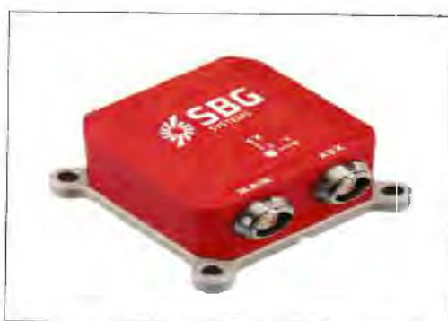
Figura 15. Inercial SGB Systems, Modelo Ellipse 2E.
