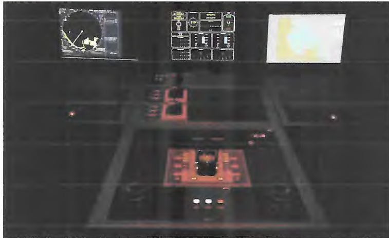
Figura 3. Consoles equipados com instrumentos reais de um navio e monitores de radar, informações da navegação e carta náutica eletrônica respectivamente, instalados no AcquaSIM.
