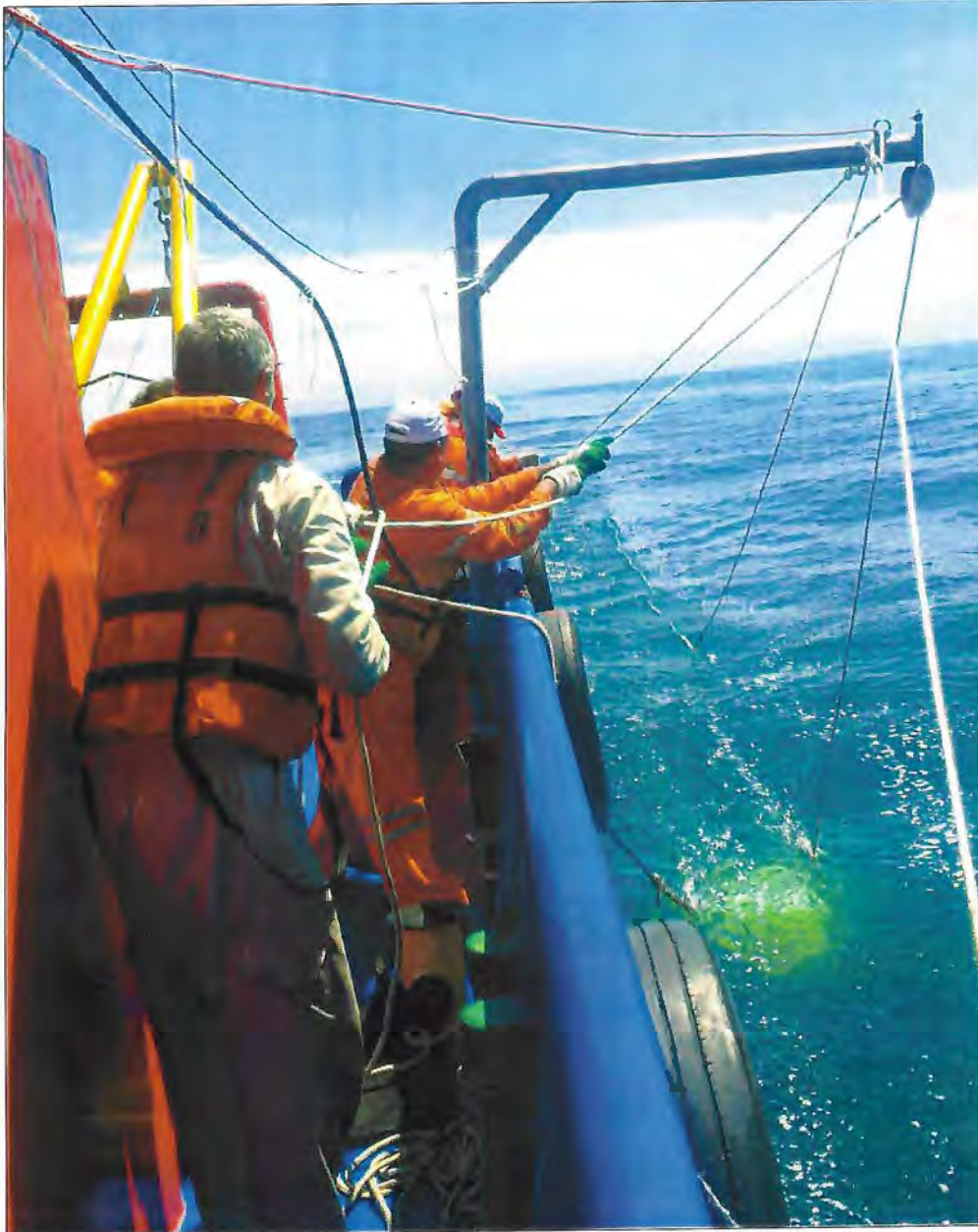
Figura 17. Estrutura de fixação e reboque do equipamento chirp , mobilizados na embarcação "Sangue Bom".
