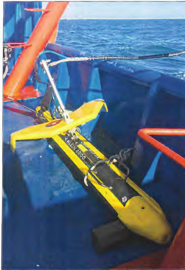
Figura 2. Sonar de varredura lateral ( sidescan sonar ) fabricante Klein, modelo 4900, mobilizado na embarcação "Sangue Bom".
