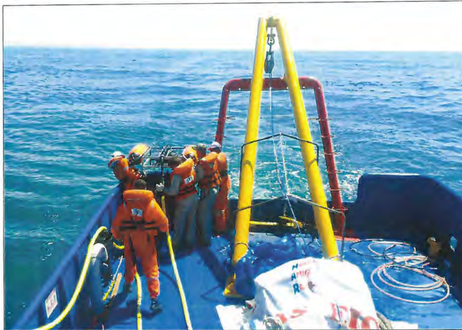
Figura 11. Lançamento do boomer na água pela tripulação e equipe técnica a bordo da embarcação "Sangue Bom".
