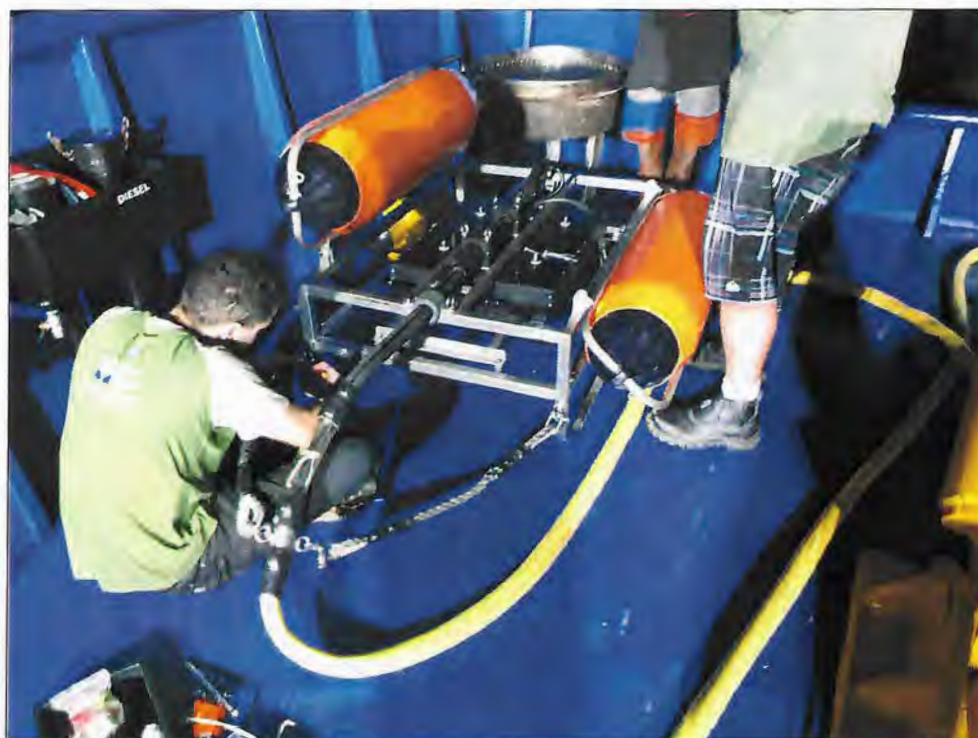
Figura 9. Instalação do boomer na embarcação "Sangue Bom".
