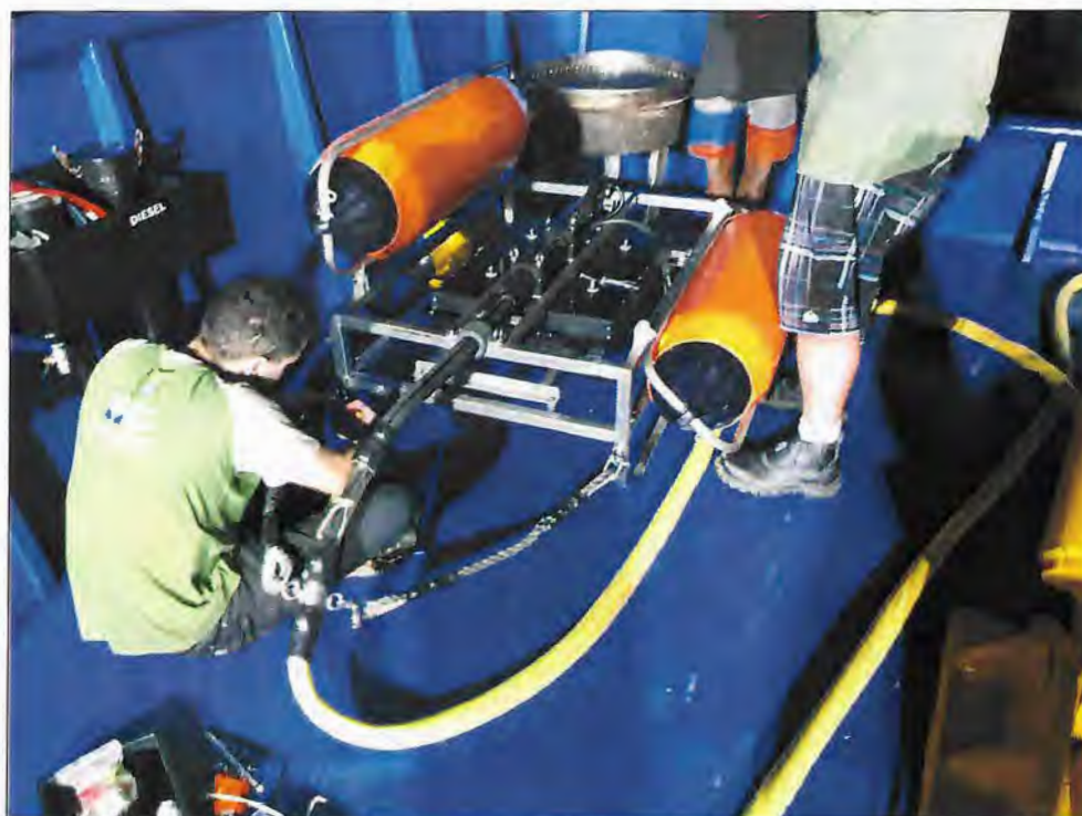
Figura 9. Instalação do boomer na embarcação "Sangue Bom".
