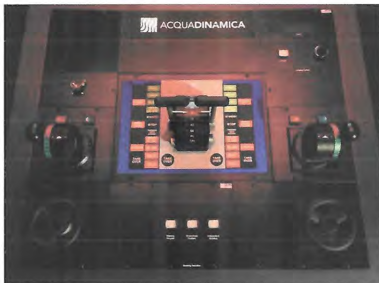
Figura 4. Detalhe do console central, com controles de lemes, controles azimutais e manetes para o controle de duas máquinas propulsoras.
