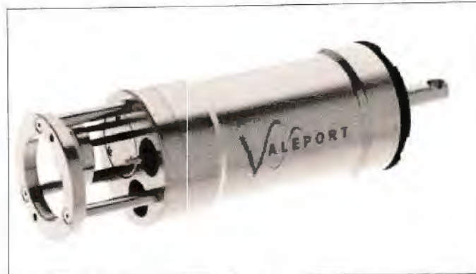
Figura 13. Perfilador de som utilizado na sondagem.
