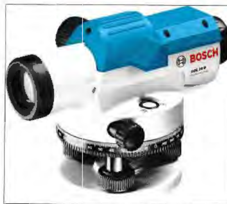
Figura 6. Nível utilizado no procedimento de Nivelamento Geométrico.
