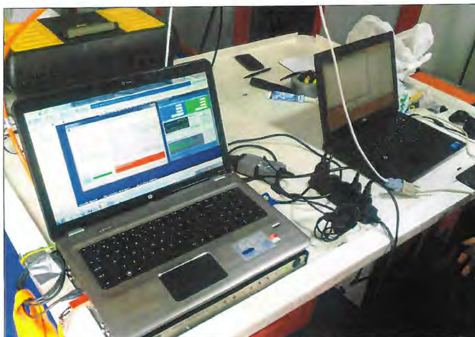
Figura 13. Bancada de operação e controle dos equipamentos boomer e chirp , instaladas nas dependências da embarcação “Sangue Bom”.
