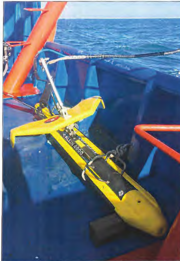
Figura 2. Sonar de varredura lateral ( sidescan sonar ) fabricante Klein, modelo 4900, mobilizado na embarcação "Sangue Bom".
