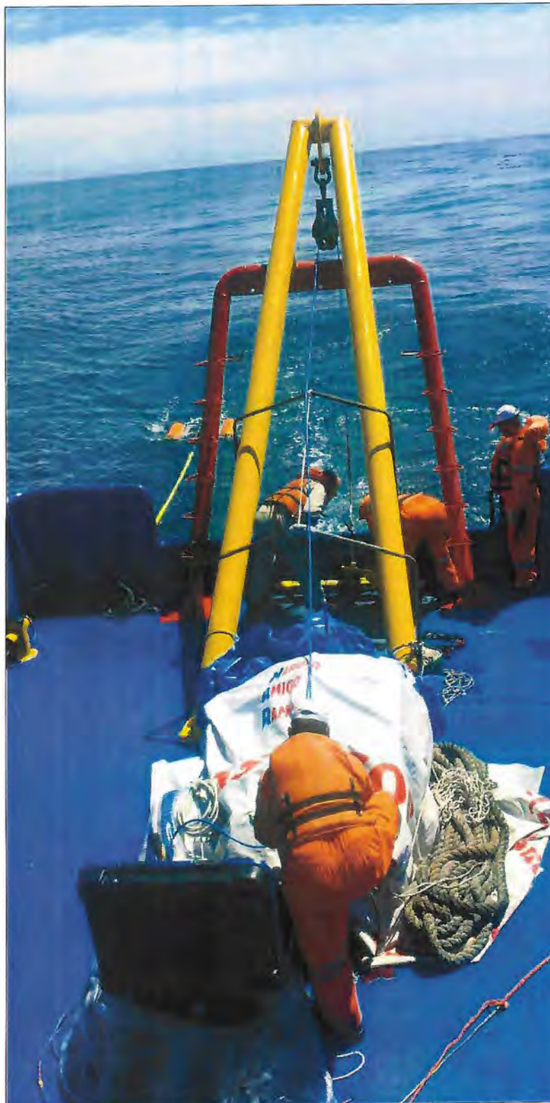
Figura 5. Estrutura de reboque do sonar de varredura lateral (em amarelo) munida do cabo de reboque do sonar (em azul).
