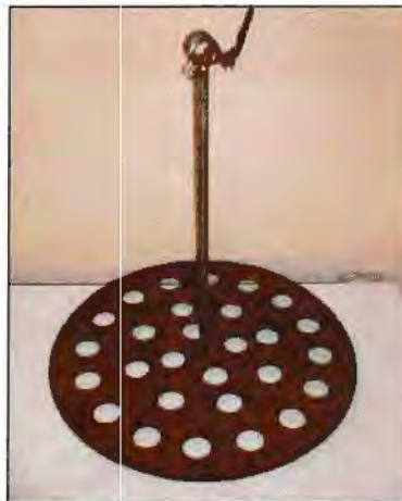
Figura 14. Disco de aferição do transdutor, procedimento conhecido como "barcheck".
