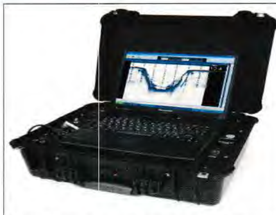
Figura 11. Ecobatímetro ODOM ECHOTRAC CVM integrado com microcomputador.
