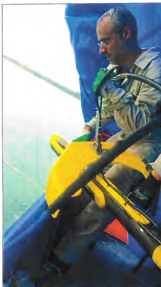
Figura 4. Procedimento de disposição do peixe do sonar de varredura lateral ( sidescan ) pelo geofísico a bordo da embarcação "Sangue Bom".
