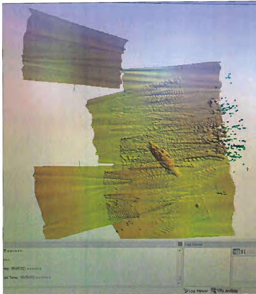
Figura 8. Registro da superfície do leito marinho pelo sonar de varredura lateral na APA Costa das Algas, revelando a presença de artefato na área levantada nos testes de mar.
