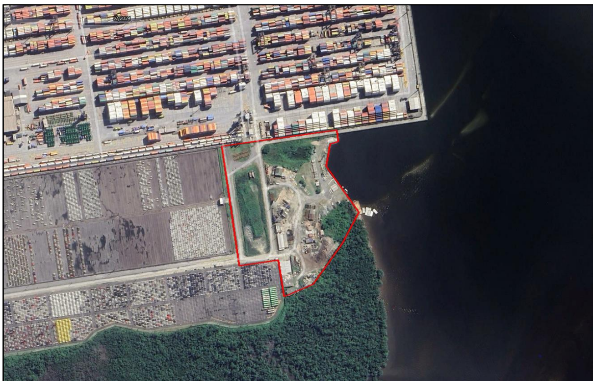
Figura 4-1. Localização da poligonal do Levantamento Topográfico, sendo a área do Canteiro P16 – APPA e área de entorno, contemplando uma área aproximada de 52.000 m 2 . Fonte: Google Earth PRO.
