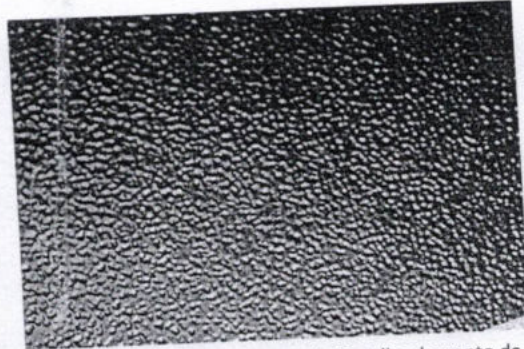
Amostra após término do ensaio. Detalhe do ponto de corrosão vermelha localizados.
