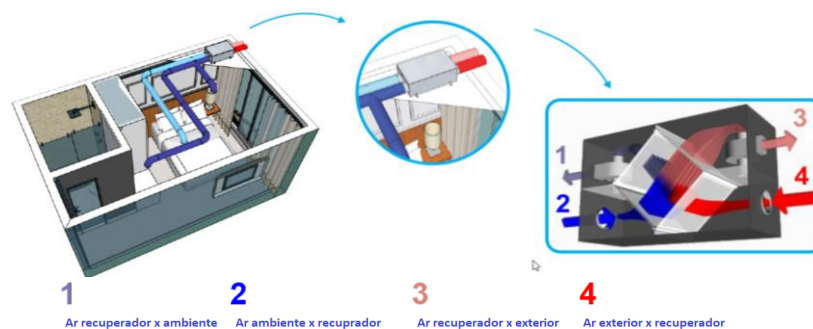
Figura 20 – Sistema de um recuperador de calor
