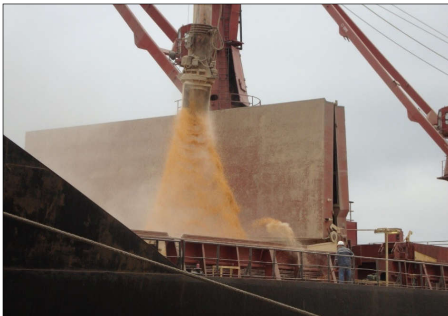
Figura 34. Operação de carregamento de granel sólido, onde é possível observar a dispersão de material particulado.
