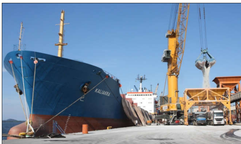
Figura 33. Operação de descarga de granel sólido, em que se observa dispersão do material particulado e deposição no pátio.
