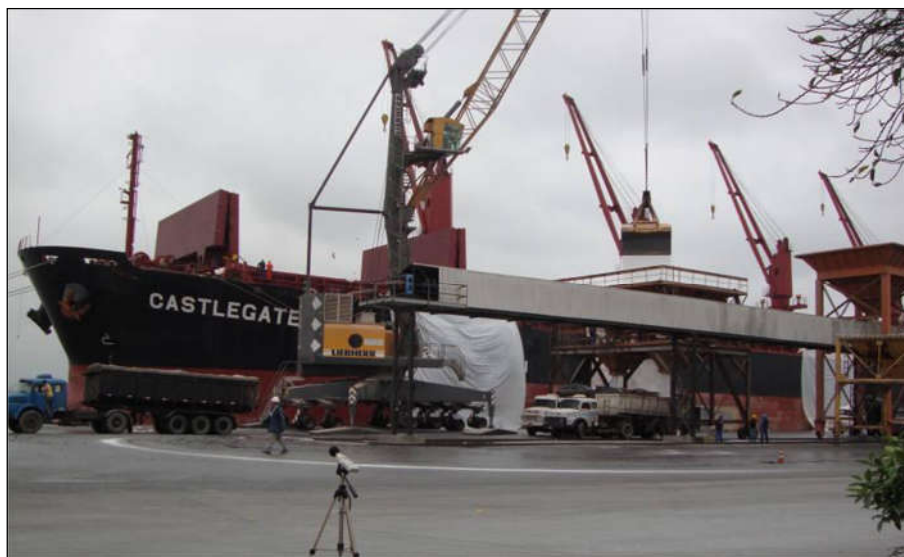
Figura 8. Operação de descarga de fertilizante no Cais Público onde é utilizado guindaste, funil e caminhões.
