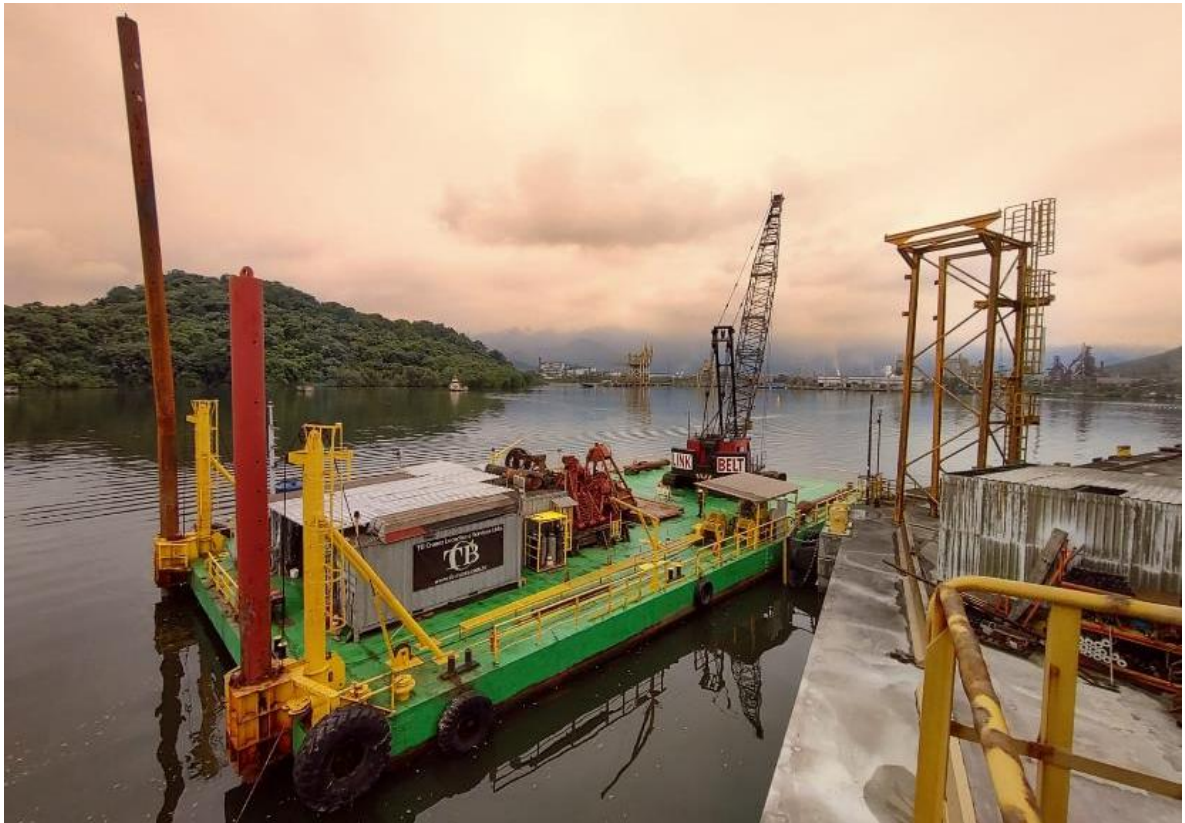
Figura 2. Clamshell sobre flutuante (TBC Conquistar).
