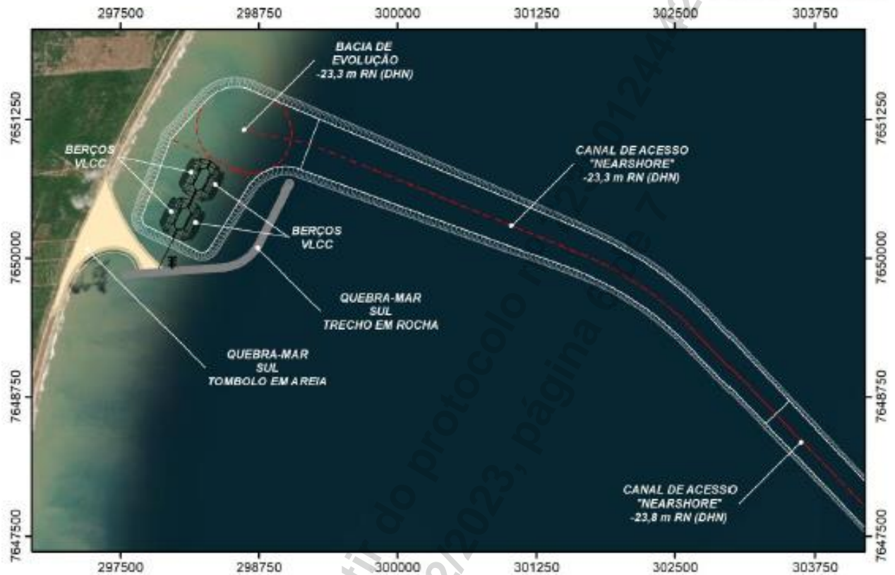
Figura 4. navegáveis projetadas, aterro hidráulico (tombolo arenoso), quebra-mar e berços de atracação do Porto Central.
